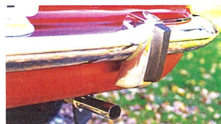
Eksoshalen er underdimensjonert i forhold til moderne biler, 1,1 liter motor på 60 hester genererte bare en liten mengde eksos.
